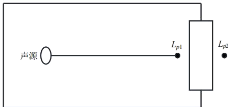
图 4-13 室内声源等效为室外声源图例
