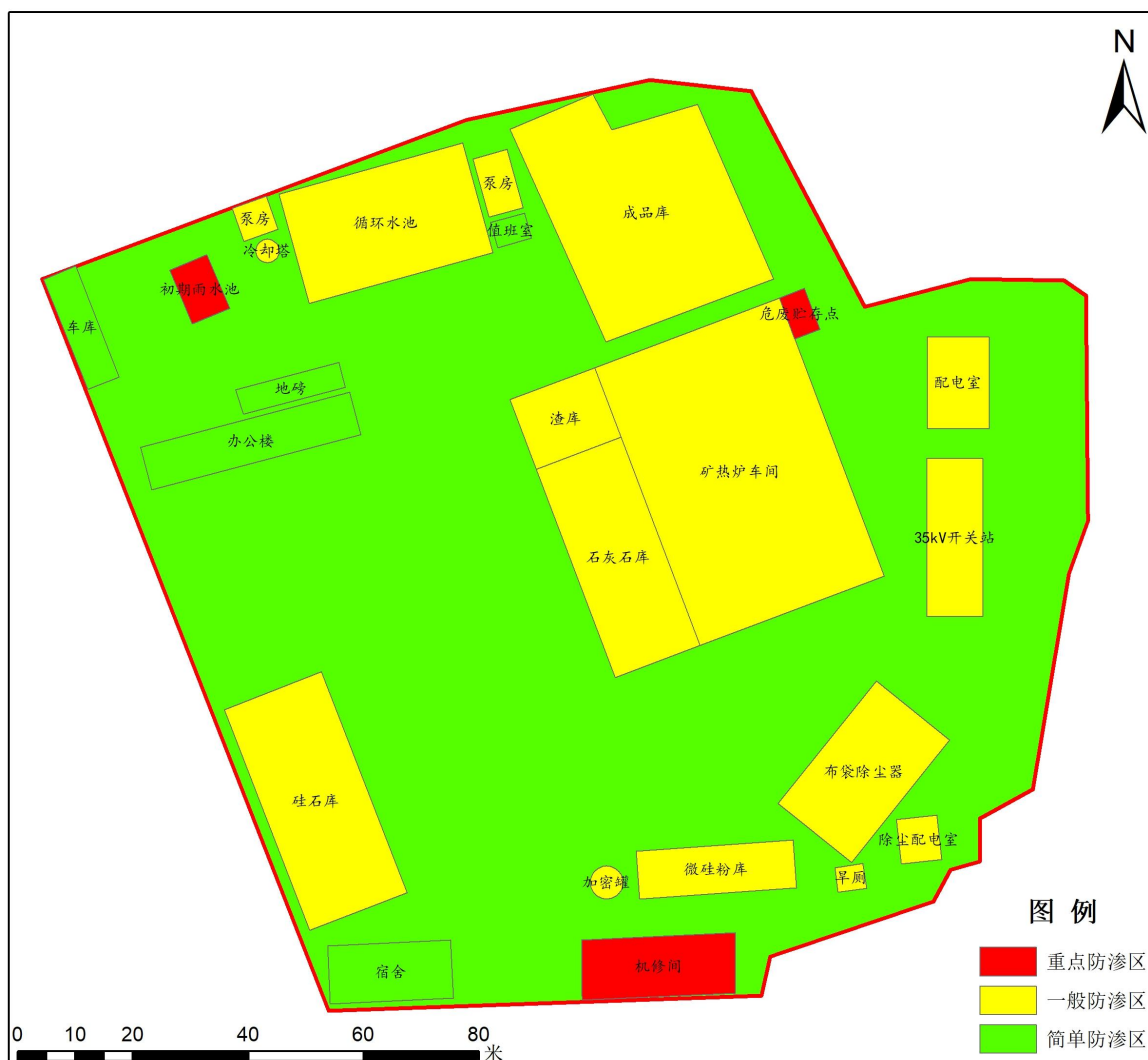
图 7.2-3 本项目地下水分区防渗示意图
