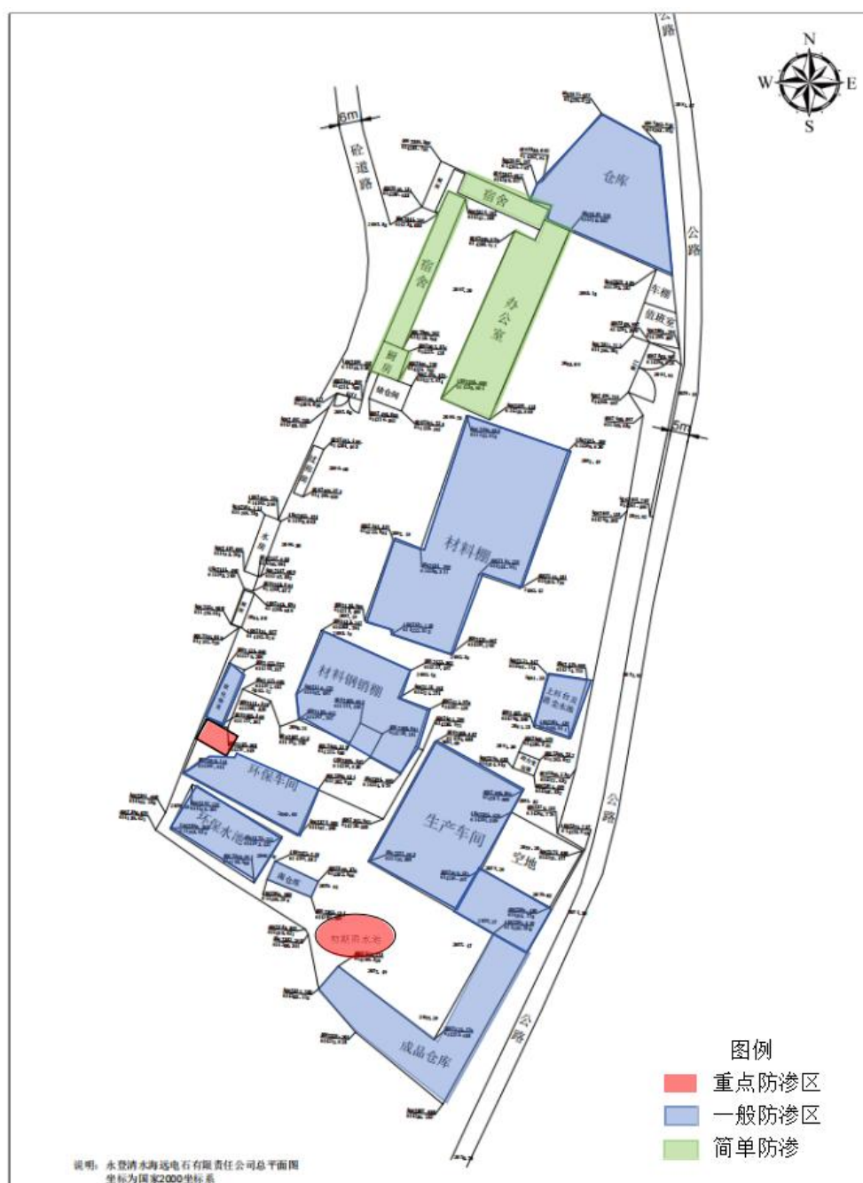
图 7.2-3 本项目地下水分区防渗图
