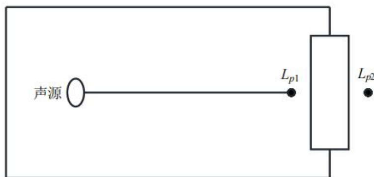
图 5.2-2 室内声源等效为室外声源图例
